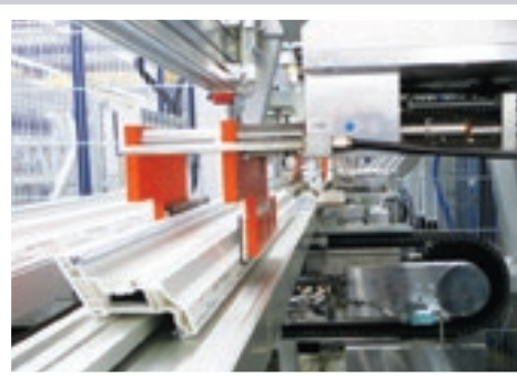
Centrum Tnąco-Obróbcze BDM FTB 100 A2 do profili PVC
