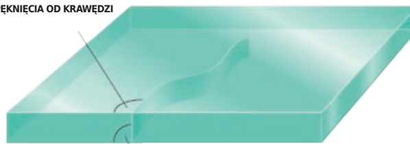
90° - KĄT PRZEZ GRUBOŚĆ SZKŁA
