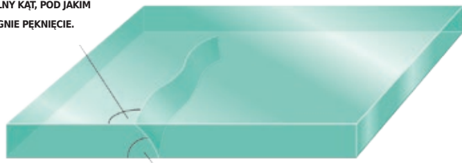
PĘKNIĘCIE PRZEZ GRUBOŚĆ SZKŁA NIE PRZEBIEGA POD KĄTEM PROSTYM.
